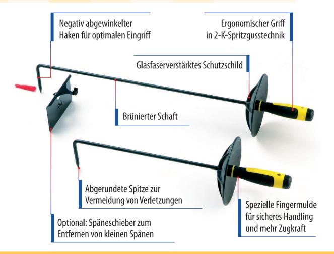
Der neue Spänehaken HOOKY mit seinem ergonomischen 2-Komponentengriff stellt in puncto Handling alles in den Schatten, was derzeit auf dem Markt verfügbar ist. Mit seinem glasfaserverstärkten Späneschutzschild entspricht er den höchsten Sicherheitsstandards und gewährleistet eine hohe Lang-lebigkeit. Die hochwertige Ausstattung orientiert sich nicht zuletzt an den berufsgenossenschaftlichen Vorgaben zur Vermeidung des Verletzungsrisikos.
