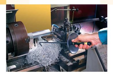
Zum Entfernen langer Schlingspäne und z.B. Kunstoffresten aus Spritzgussmaschinen. Der stabile Haken besitzt eine "stumpfe" Spitze, welche eine Verletzungsgefahr vermindert.
